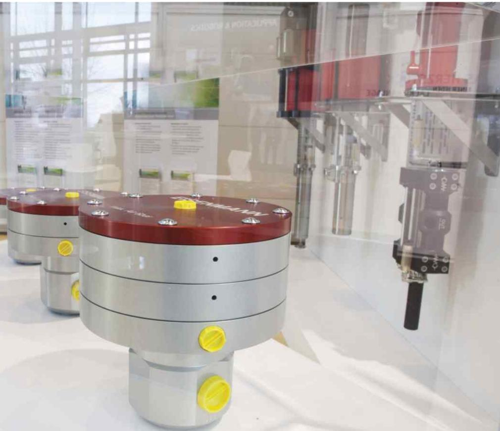
Новые высоконапорные насосы, установленные для снабжения материалами станций герметизации швов и защиты днища кузова, позволяют индивидуально интегрировать различные сборные узлы для регулирования подачи и обратного давления
