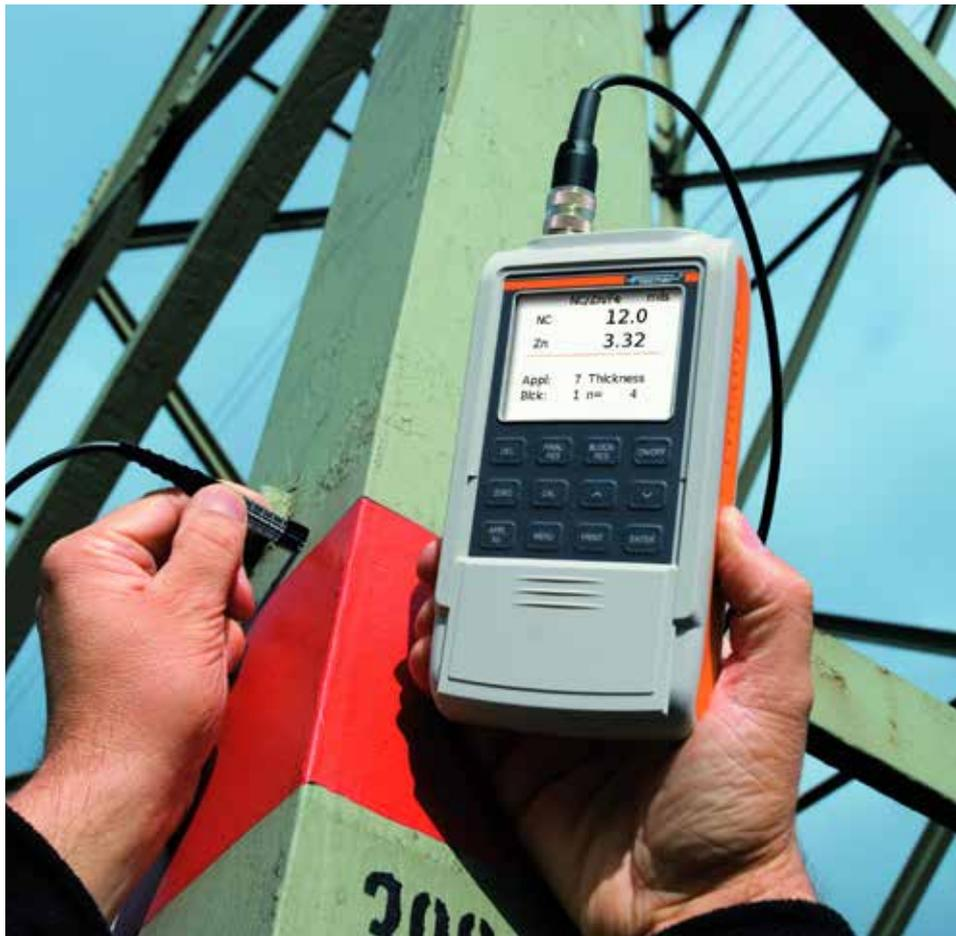
Одноступенчатое измерение duplexного покрытия (лак / цинк / сталь) на силовой опоре с помощью Dualscope FMP40 и duplexного датчика
