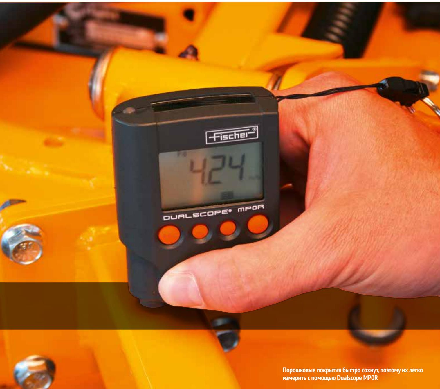
Порошковые покрытия быстро сохнут, поэтому их легко измерить с помощью Dualscope MPOR
