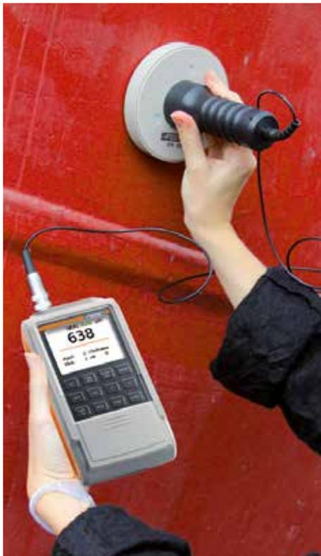
Точное измерение толщины покрытия на контейнере с помощью Dualscope FMP100
