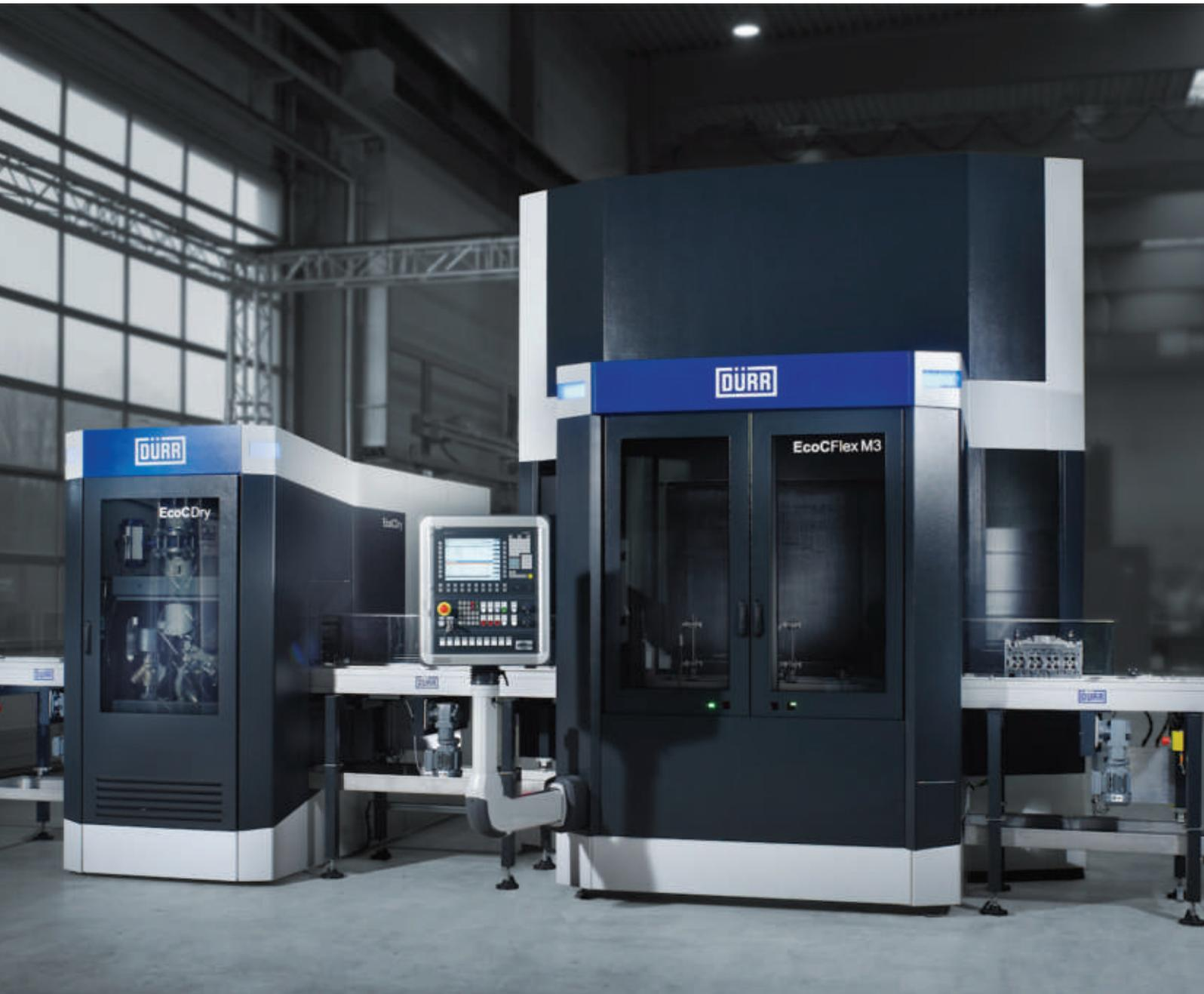
Один управляющий блок с ЧПУ для системы EcoCFlex 3 с манипулятором SKARA заменяет использовавшиеся прежде ПЛК и устройство управления роботом. Сушка деталей происходит без сжатого воздуха с помощью энергоэффективной и быстрой сушилки EcoCDry
