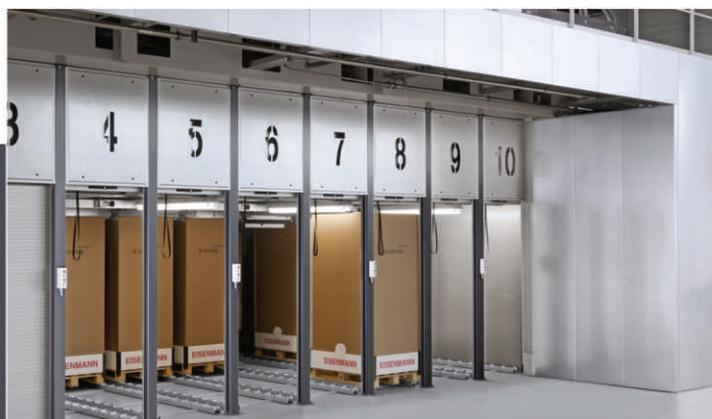
Кубики в механических системах сухого осаждения отличаются высокой поглощающей способностью. При необходимости их можно быстро и легко заменить, не останавливая работу системы
