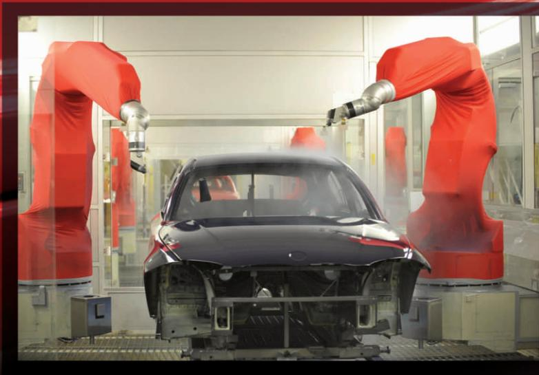
Использование высокоскоростных роторных поворотных форсунок с почти 100-процентной эффективностью передачи и окрасочных роботов способствует экономии материалов. Переход от прямого забора и отдачи воздуха к системе рециркуляции воздуха позволяет сэкономить от 60 до 70% энергии
