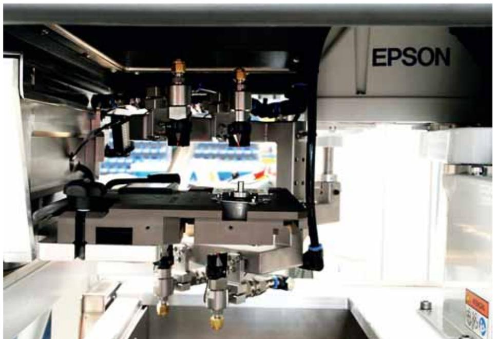
В соответствии с конкретными требованиями по устранению заусенцев, чистоте и времени цикла разрабатываются индивидуальные системные концепции. Здесь процесс осуществляется одновременно сверху и снизу
